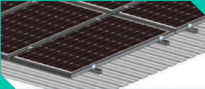
Para cada Mrail de 6,20 mts se requiere fijar 4L y para cada Mrail de 4,15 mts se requieren 3L. Al utilizar el accesorio Alurack L, observa que el Mrail se posiciona de canto (de lado).
